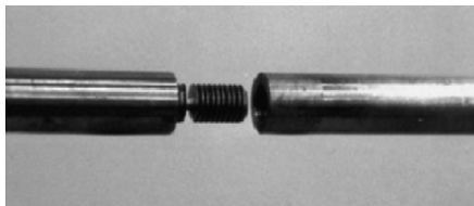
شکل ۲ جزئیات نمونه در تست میله‌هاپکینسون کششی [۸]
